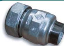
No caso das Juntas Rápidas de transição (juntas rápidas macho, fêmea e tês), na extremidade de ligação à tubagem através de união roscada, são utilizadas **roscas de ligação, com estanquidade no filete**. Sendo as roscas exteriores cônicas (R) e as roscas interiores cilíndricas (Rp), em conformidade com a norma NP EN 10226-1 (ou ISO 7-1).
