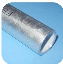
**Tubo de aço para canalizações**, conforme norma europeia NP EN 10255, da série média, submetido a 100% a ensaios de estanquidade hidráulico a 50 bar. Fornecido com revestimento de protecção galvanizado conforme norma europeia NP EN 10240.
