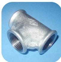
**Acessório de ferro fundido maleável roscado para canalizações**, conforme norma europeia NP EN 10242-símbolo de projecto A. Fornecido com revestimento de protecção galvanizado conforme norma europeia NP EN 10242.
