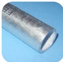
**Tubo de aço com aptidão para roscagem e soldadura, de aplicação gás,** conforme EN 10255, da série média, submetido a 100% a ensaios de estanquidade hidráulico a 50 bar e da costura por correntes de Eddy conforme EN 10246-3. Fornecido com revestimento de protecção galvanizado conforme EN 10240.
